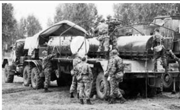
vykládání raketového kontejneru 9Ja234 a kontejneru hlavice 9Ja236
