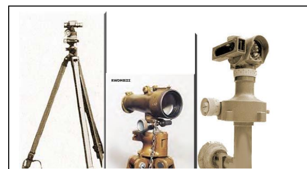
Buzola PAB-2 a kolimátor K-1 a zaměřovač PG-1
