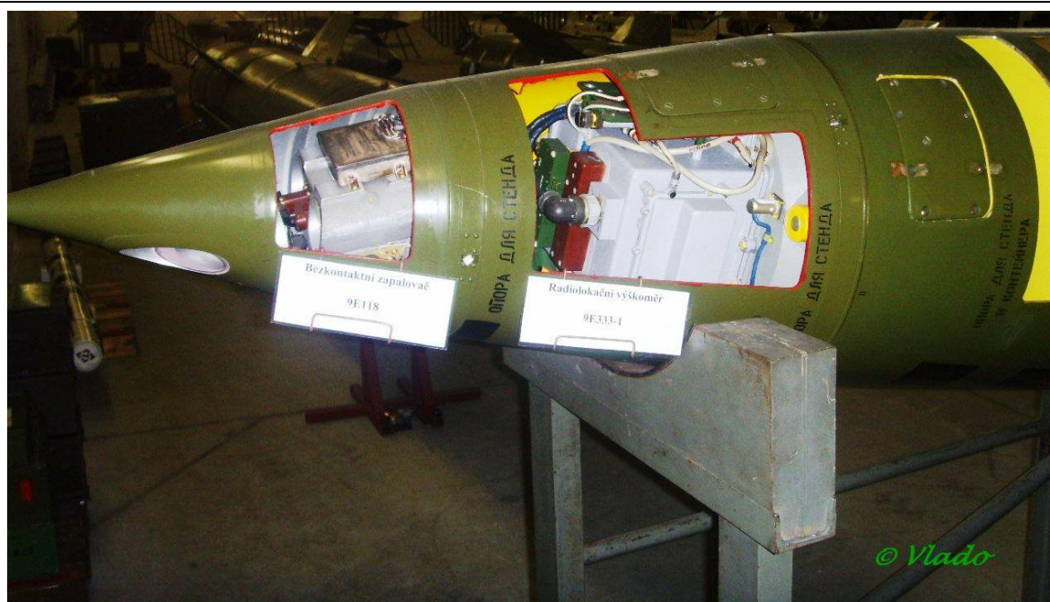
detail: Bezkontaktní zapalovač 9E118 (vlevo) radiolokační zapalovač 9F333 (vpravo)
