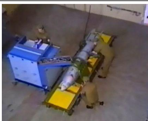
TAKT 51 ve stacionárním provedení (práce na jaderné pumě -tak mohl být používán i ve skladech)
