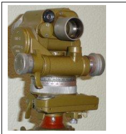
Buzola Pab-2A (bez azimutálního nástavce)
