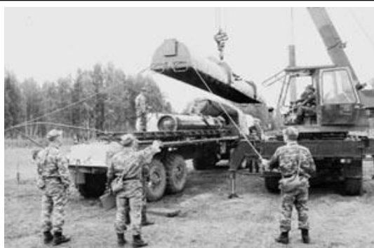
otevírání kontejneru 9Ja236 na 9M79 systému TOČKA
