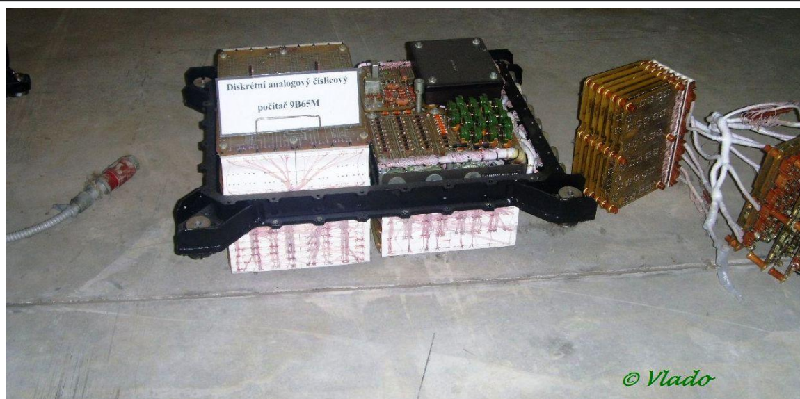
detail: Digitální analogový číslicový počítač 9B65M
