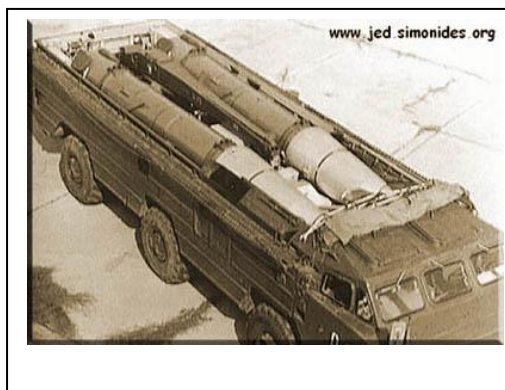
9T218 naložená 2 raketami (Foto: www.jed.simonides.org ) 9W819 s raketou 9M79
