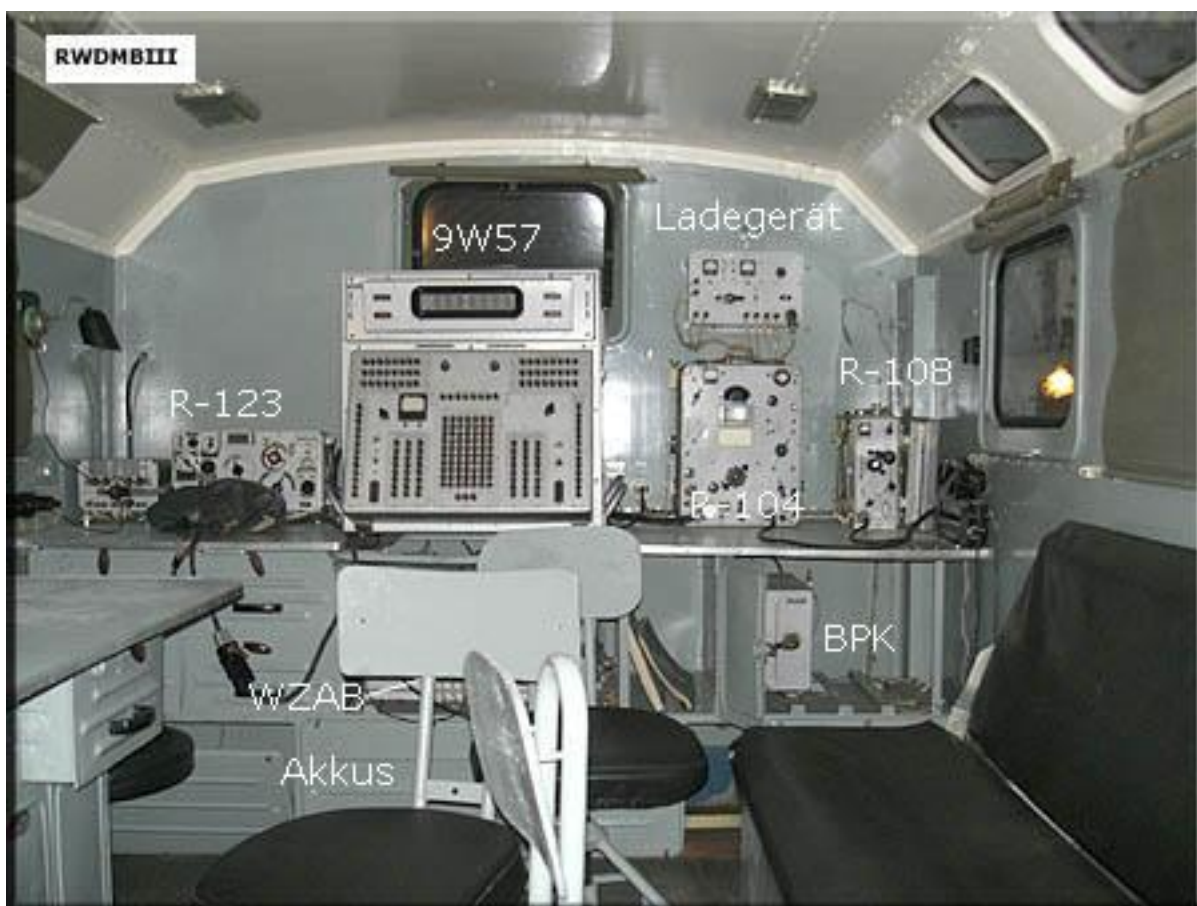
Vnitřní prostor a vybavení PU-2M
